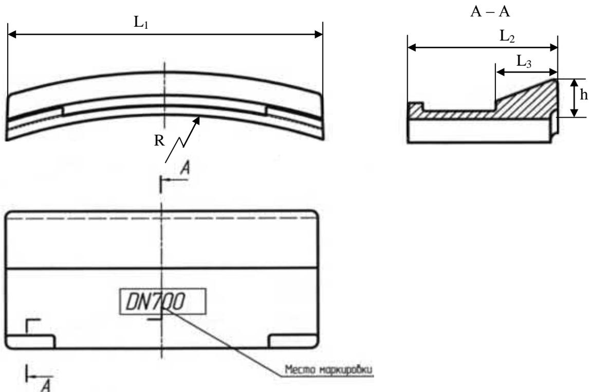
Рисунок А.7 – Стопорный элемент для соединения «RJS»
