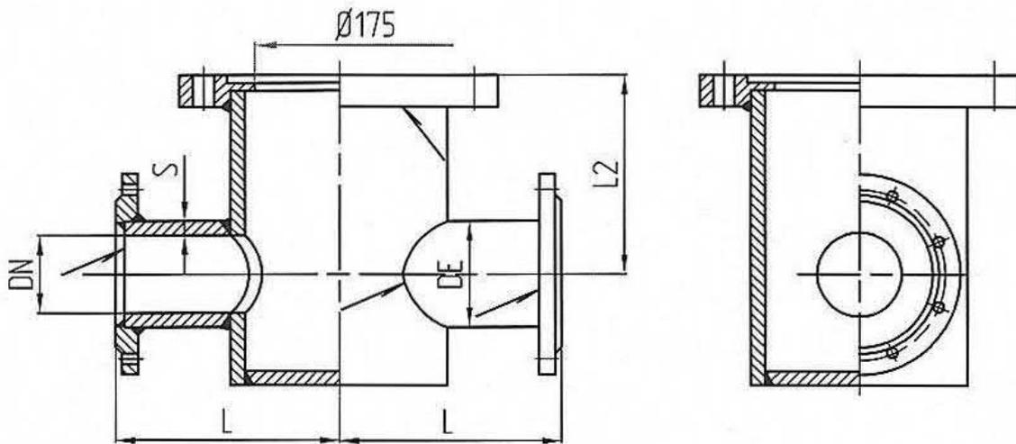
Пожарная подставка фланцевая DN100-150 мм
