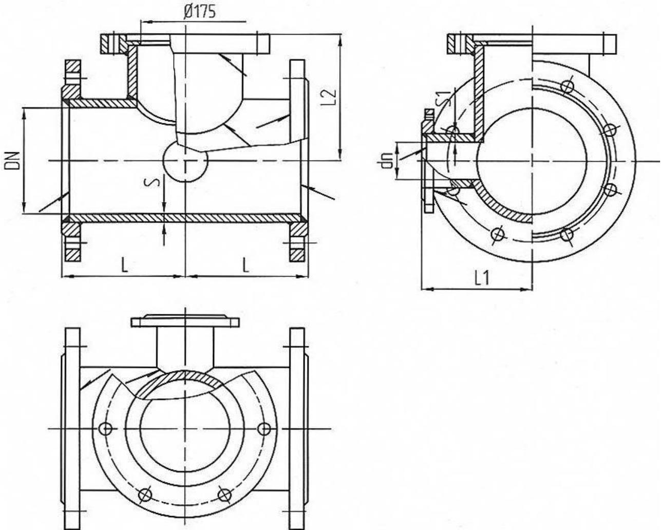
Тройник фланцевый с пожарной подставкой свыше DN150 мм
