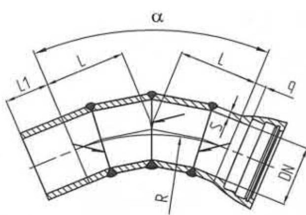
ОР  $\alpha=60^\circ$  DN400-1000 мм
