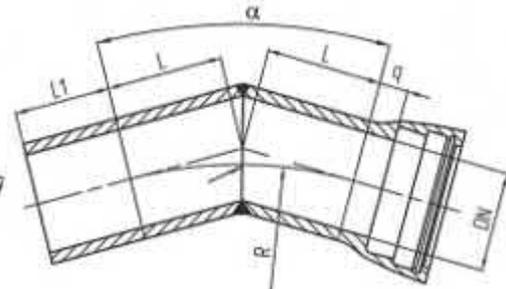
ОР  $\alpha=45^\circ$  DN80-600 мм
