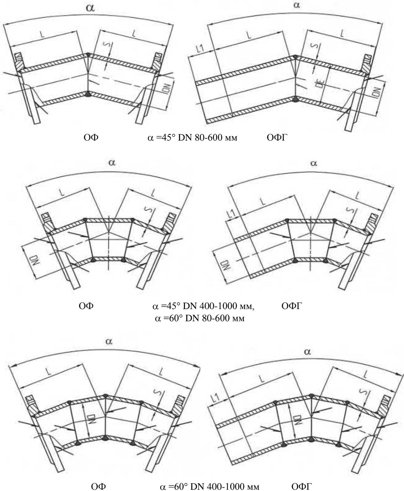
Рисунок 12.17 - Отводы  $\alpha = 45^\circ/60^\circ$
