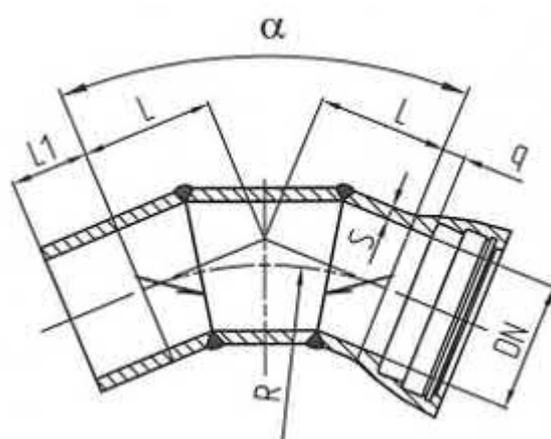
ОР  $\alpha=45^\circ$  DN400-1000 мм
