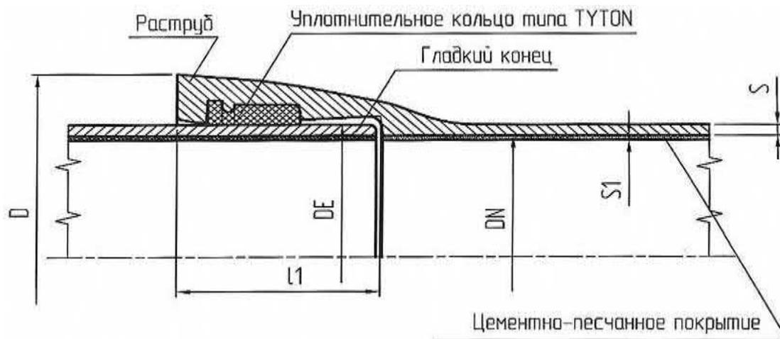
Рисунок А.1 - Раструбное соединение «TYTON»
