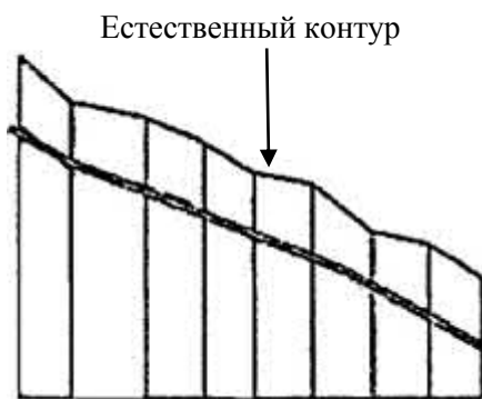
Рисунок 5.5 Трубопровод с постоянным уклоном.
