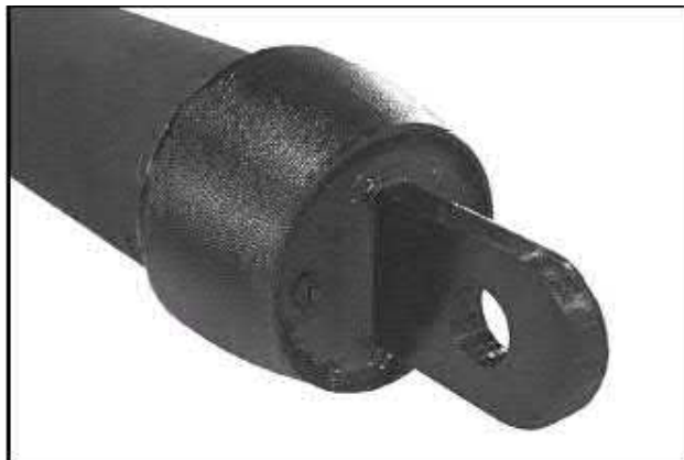
Рисунок 6.21 Приспособление для протягивания труб.
