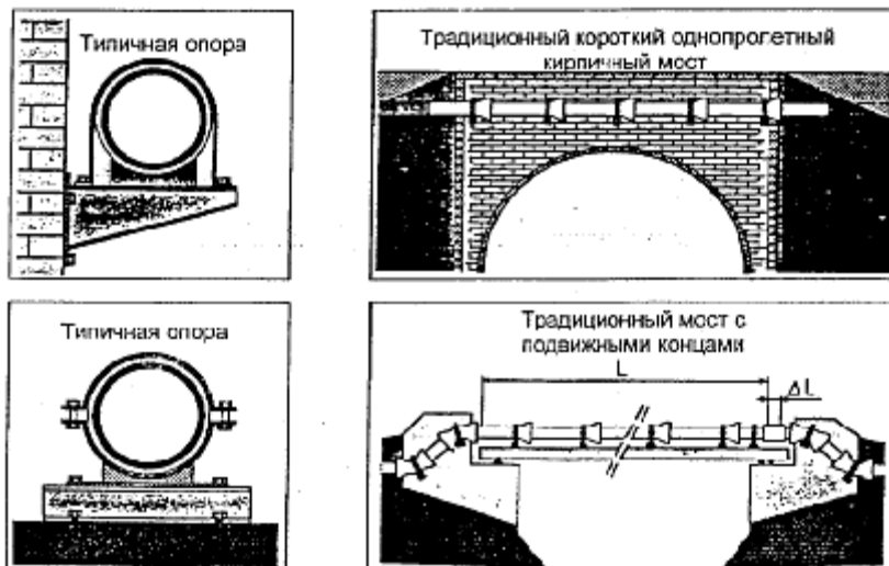
Рисунок 6.32 Трубопровод, закрепленный на сооружении.
