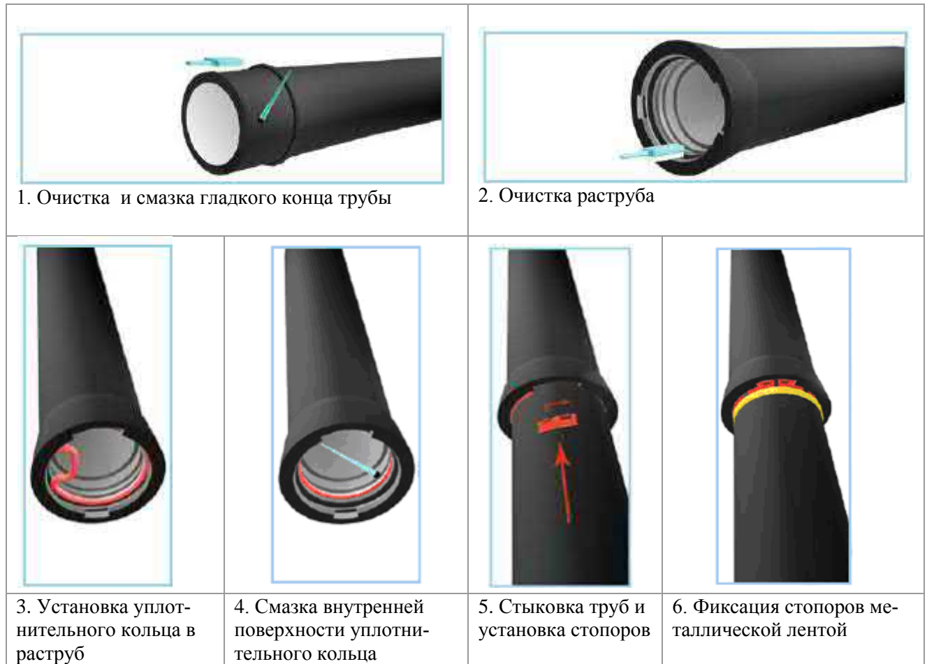
Рисунок 6.6 Монтаж труб с соединением RJS.
