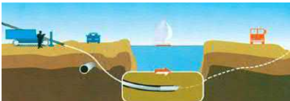
Рисунок 6.18 Бурение пилотной скважины.
